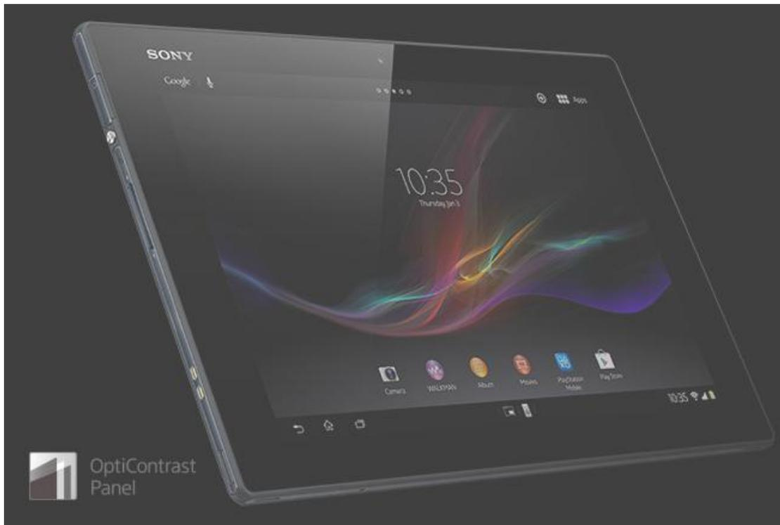
**Меньше бликов благодаря панели OptiContrast™.** Мы удалили слой воздуха из конструкции планшета Xperia Tablet Z и расположили сенсорную панель ближе к дисплею. Панель OptiContrast™ уменьшает количество бликов и повышает четкость изображения даже при ярком солнечном свете, а также обеспечивает безупречно черную поверхность, когда HD-планшет выключен. Удаление сенсорного слоя и интеграция сенсоров в дисплей позволили также увеличить чувствительность экрана.
